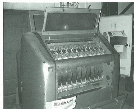
»Rajkai« snitemaskinen, der del kernen i fire, blev patenteret i 1950'erne.
