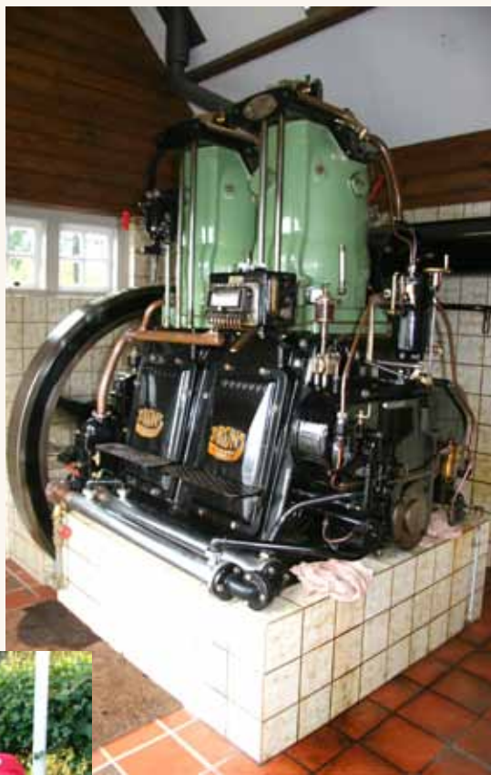
Den tocy lindrede dieselmotor fra firmaet "BRONS", ses her ved møllen "De Korenaar" total istandsat og skinnende blank.
