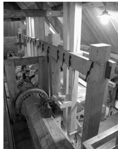
Besøget på Kilsdonkse Molen var sidste møllebesøg på turen, og for de fleste et af højdepunkterne. Her ses den næsten 16 m. lange knastaksel med stamper i oliemøllen.
