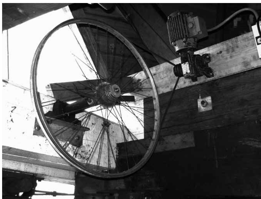
For at lette arbejdet blev der fremstillet dette apparat til at dreje hatten med.
