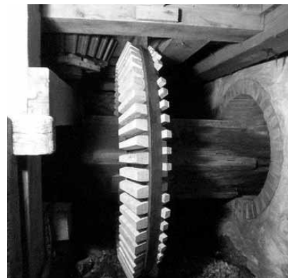
De nye kamme i gravhjulet på Ørnbjerg vandmølle.
