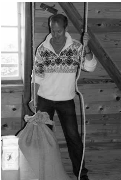
Sækkehejs demonstreres af en af de femten møllersvende på Baunhøj Mølle.
